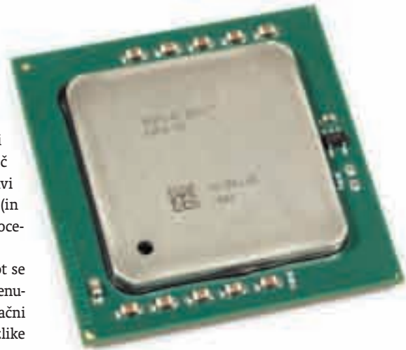
» Intelov strežniški adut je Xeon, ki ima v najnovejših različicah dve jedri in podporo 64-bitnim programom.
