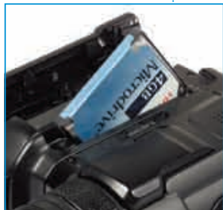
» Namesto kasete miniDV v kamero vstavimo Hitachijev Microdrive.
