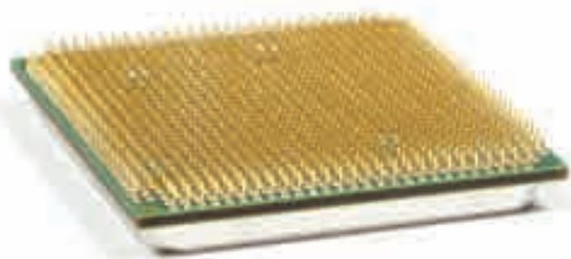
» AMD (zaenkrat) pri svojih procesorjih še vedno prisega na nožice.
