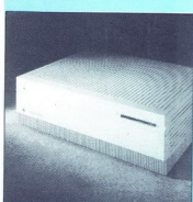
Macintosh IIfx CPE: 68030 FPU: 68882 MHz: 15,68 ROM: 256 K DIP pričvrščen max RAM: 8 Mb reže: 3 - NuBus gibki disk: FDHD zunanji pomnilnik: SCSI, gibki disk tipkovnica: standardna, razširjena, miška ADB barva: da zvok: stereo, lasten čip
