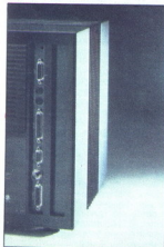
Slika 1: NeXTovi priključki (od zgoraj navzdol: vrata DSP, dvoje serijskih vrat, vrata SCSI, vrata za laserski tiskalnik, vrata za Ethernet in vrata za monitor).
